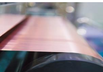
印制电路板用超厚电解铜箔
